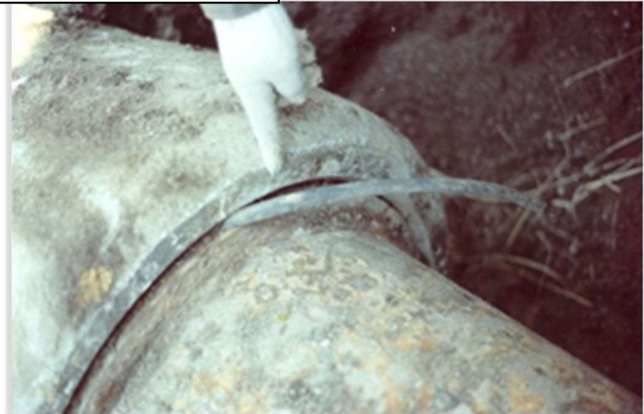
老朽化による管体破損状況
