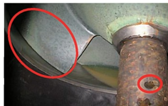
羽根車の歪みや主軸の孔食
