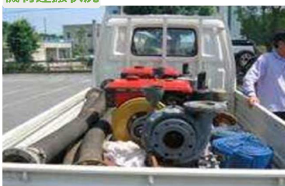
【φ150 揚程25m 吐出量2.0m 3 /min】 【φ100 揚程35m 吐出量1.0m 3 /min】
