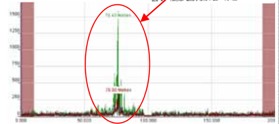
図-1 相関式漏水探知器の原理
