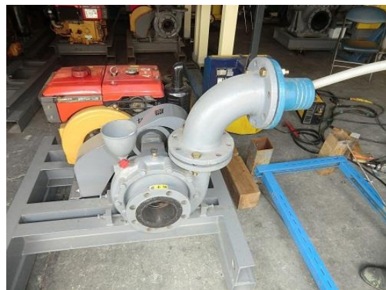
【給水ポンプにより、吐出口から充水している状況】
