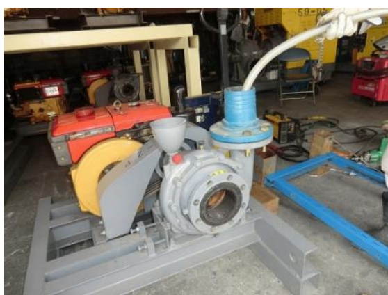
【吐出口に給水ポンプによる充水の例】 (写真ではスルースバルブ取付けを省略しています)
