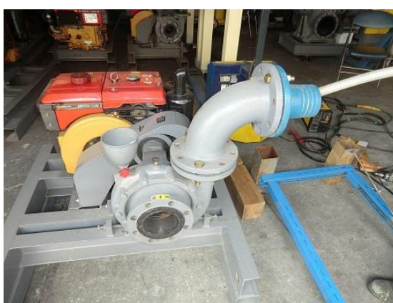
【吐出口に給水ポンプによる充水の例】 (写真ではスルースバルブ取付けを省略しています)
