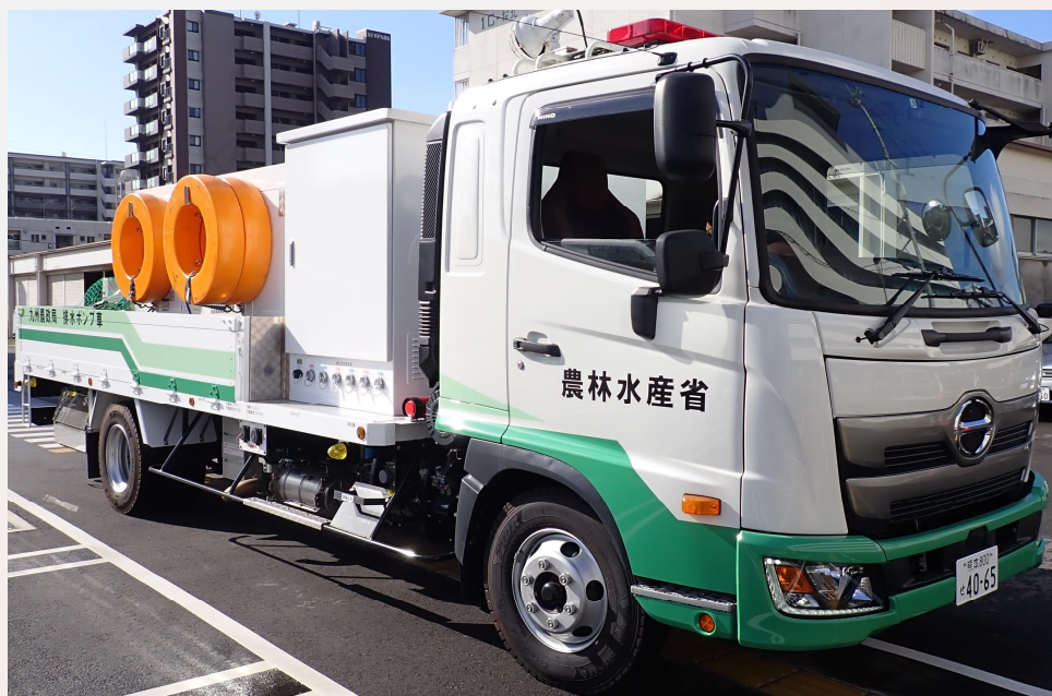
8トン排水ポンプ車
