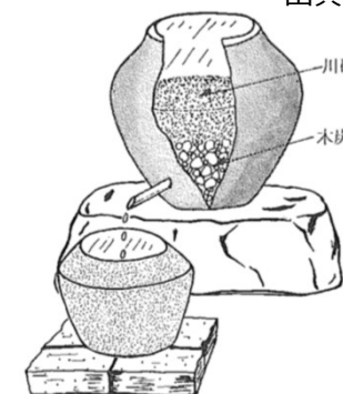
クリークの水を貯めてろ過する 「はんづうがめ」の構造 出典：佐賀市史
