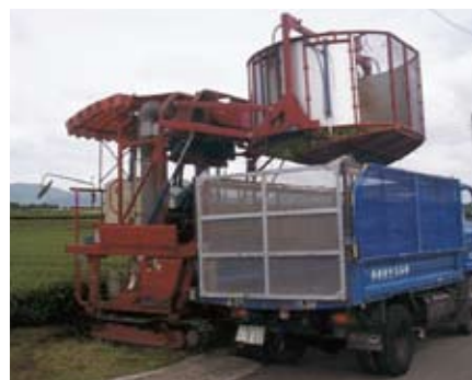
コンテナ式一条型摘採機と生葉運搬車(上) 共同で行う被覆作業の様子(左)
