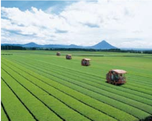
乗用型摘採機による摘採の様子
