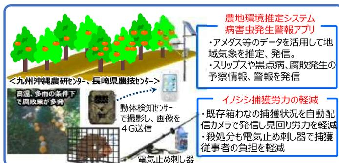
図3 病虫害防除・害獣捕獲
