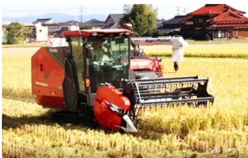
○ 自動運転作業は、水稲・麦について有人自動(乗車)で利用する。外周3周以上は手動運転し、内側を自動運転可能。収穫物が満載で指定積み込みポイントへ自動で移動する。
