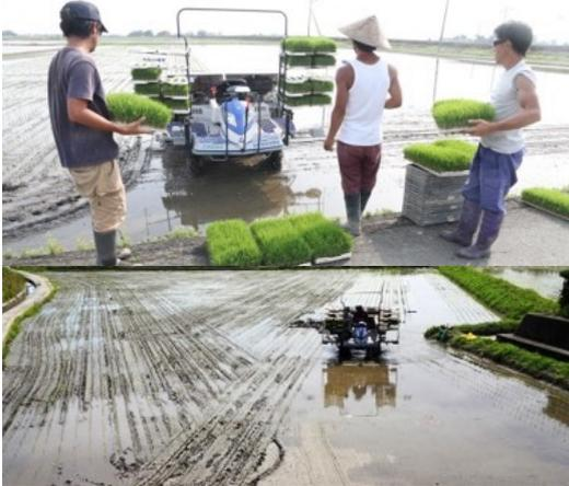
変形圃場での自動運転田植え機作業の様子
