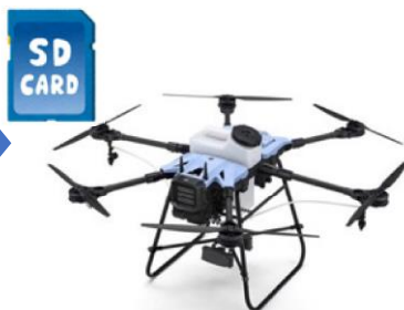
可変散布機能をもつドローン へマップデータ入力
