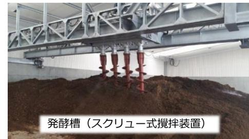
発酵槽（スクリュー式攪拌装置）
