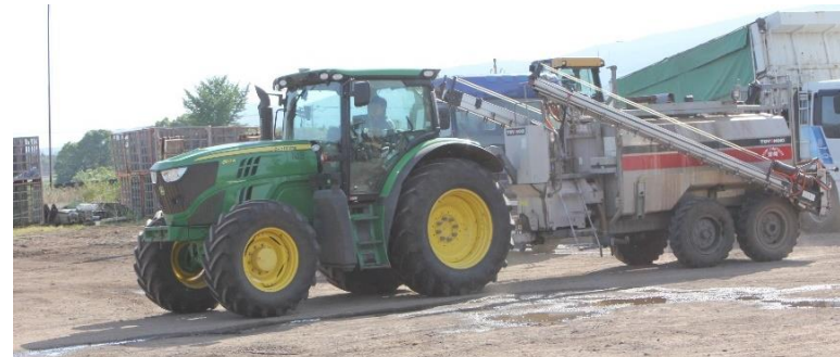
全長28メートルブーム付き散布機の牽引
