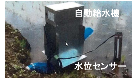
自動水門 (AGLモデルプロトタイプ)
