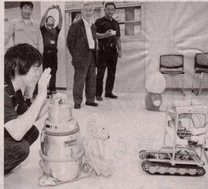
搭載カメラで送った映像をもとに遠隔操作で動くロボット
