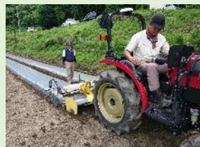
自動操舵トラクター、うね立てマルチの導入による除草作業の省力化
