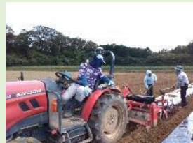
自動操舵システム付きトラクタを用いた耕起作業の省力化
