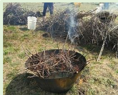
無煙炭化器による 夏季剪定枝の炭化处理
