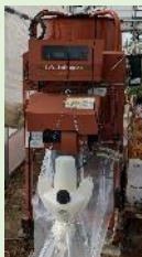
灰色かび病防除 生物農薬自動ダクト散布
