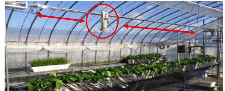
写真 栽培ベッド上を往復移動する超音波照射装置（広範囲の株に超音波を照射することが可能）
