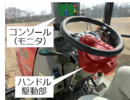
自動操舵システム（後付け型）のトラクターへの装着事例
