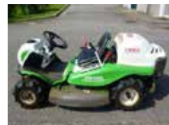
乗用草刈機による粉碎処理 時速2.5km(45分/10a)で2回
