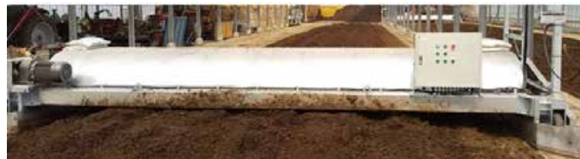
基礎なしロータリー式攪拌機
