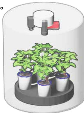
非破壊で経時的に3次元計測することにより、4次元化、生育の変化を捉える。
