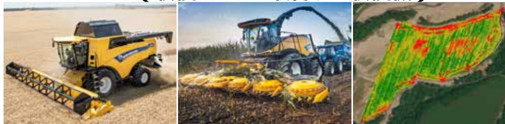
圃場内の場所ごとに計測される収量及び水分データから作成される収量マップ（次期作の施肥設計に活用）
