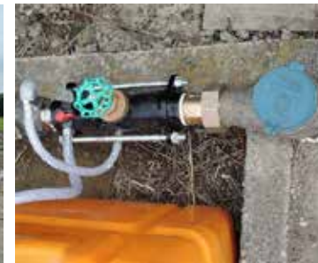
ほ場に配置したかん水チューブとエタノール混入器 (液肥混入器を利用)
