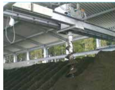
フジキ式スクリュウ 発酵攪拌機
