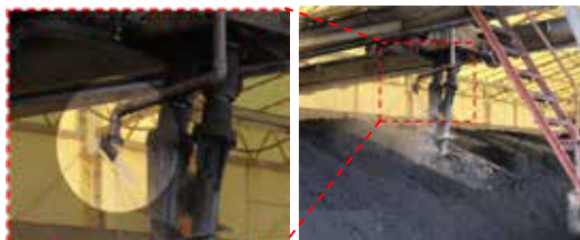
横行型スクリー式攪拌機による鶏ふん堆肥への焼酎蒸留廃液の散布
