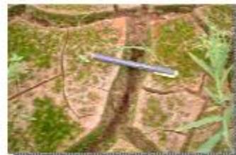
水田で耕作が放棄されると、地表面付近の乾燥化が進み、乾裂が入る
