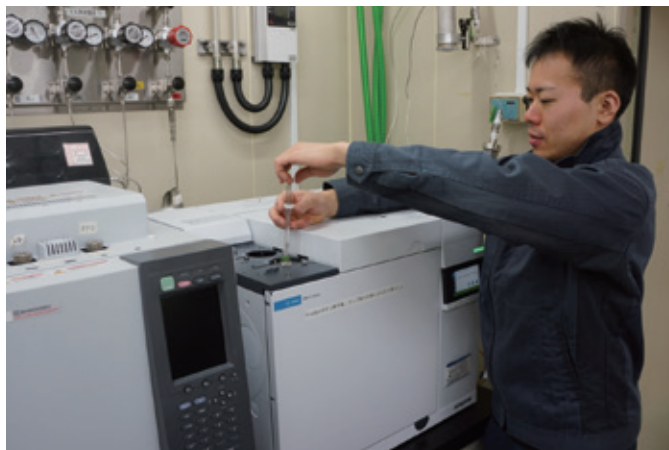
ガスクロマトグラフを用いたくん蒸剤のガス濃度測定
