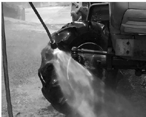
高圧洗浄機を用いた洗浄
