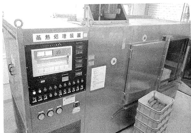
那覇植物防疫事務所の蒸熱処理装置
