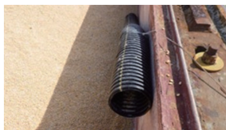
穀層上から船底に配管されたパイプ
