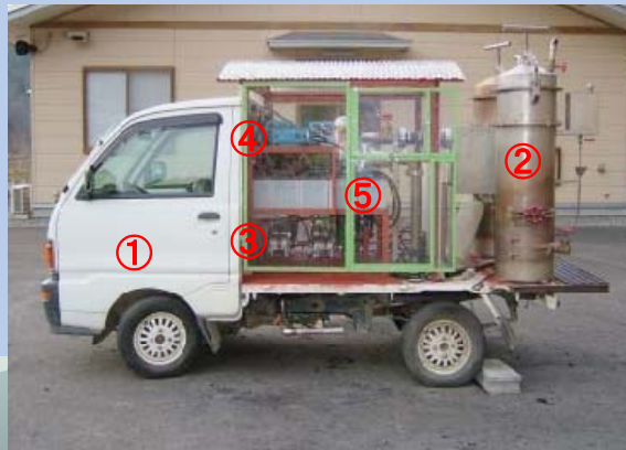
②木炭水性ガス 発生装置×2基 木炭約23[kg/基・回] 直径約400[mm] 高さ約1200[mm]
