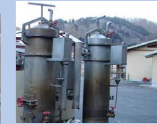
②木炭水性ガス 発生装置×2基 木炭約23[kg/基・回] 直径約400[mm] 高さ約1200[mm]
