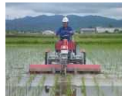
省力的な有機栽培を可能とする高能率水田用除草機
