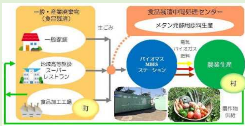
食品廃棄物を活用したバイオマスプラントから発生する 電気・ガス・消化液（肥料）の地域農家等への提供
