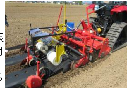
自動操舵アシストトラクター 熟練者と同等以上の精度・速度 で耕起・畝整形・マルチ展張・播 種を同時に作業可能
