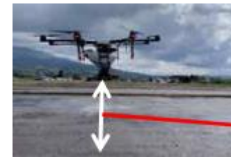
粒材散布装置を搭載した農業用ドローンで播種。
