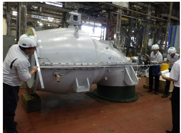
排水ポンプ性能試験実施状況（工場内試験）
