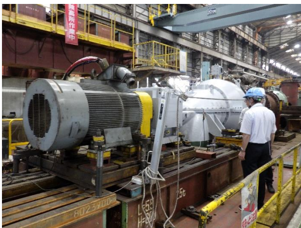
排水ポンプ性能試験実施状況（工場内試験）
