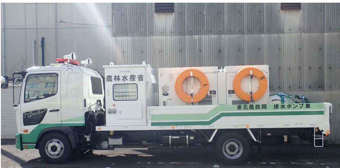
○排水ポンプ車:30m 3 /min水中モーター式
