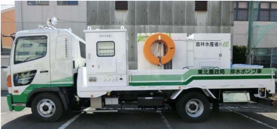
○排水ポンプ車:20m 3 /min水中モーター式
