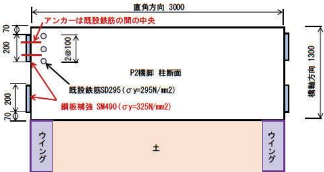
図- 3.10.3 段落し補強概要（柱断面図）
