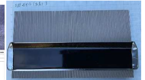
型取りによる骨材露出調査
