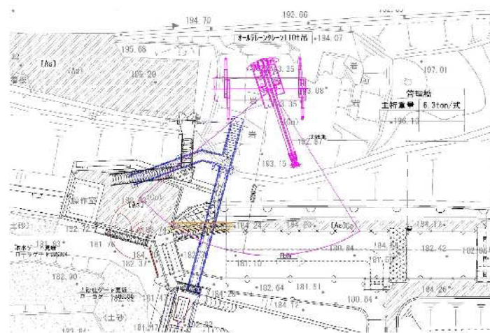
クレーン吊込み要領
