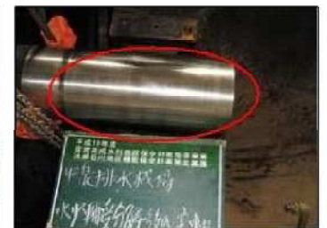
【摺動部(軸受スリーブ)の摩耗状況】
