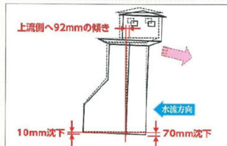
堰柱の沈下及び傾倒
