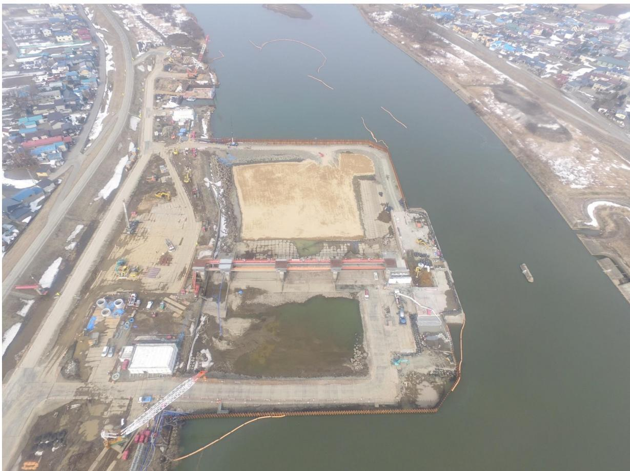
2期工事施工状況（洗掘部埋戻完了状況）
