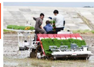
ペースト施肥付き田植え機で田植えをする奥松島グリーンファームの従業員ら
