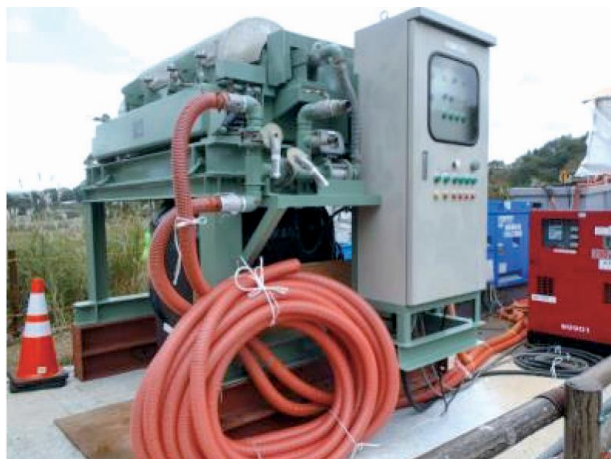
スクリーデカント型遠心分離機（側面）
