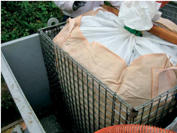
重力脱水：脱水カゴによる一次脱水
