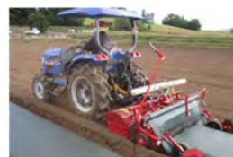
マルチロータリーで、畝立てとマルチ張りを同時作業
