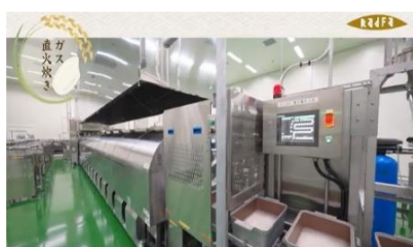
新工場内部「パックご飯製造ガス直火炊き」
