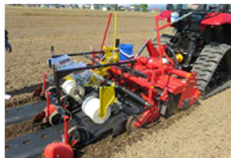
自動操舵アシストトラクターに、耕起・畝整形・マルチ展張・播種を同時に行うアタッチメントを取り付けて作業を省力化
