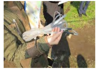
加温に使用している電熱線ヒーター
