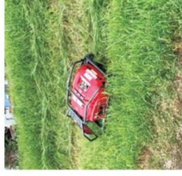
傾斜地の多い中山間地域におけるリモコン草刈機の導入（法面の緩傾斜化）
