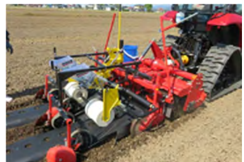
自動操舵アシストトラクターに、耕起・畝整形・マルチ展開・播種を同時に行うアタッチメントを取り付けて作業を省力化
