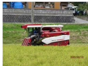
収量計測可能なコンバイン
