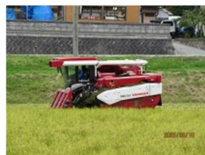
収量計測可能なコンバイン
