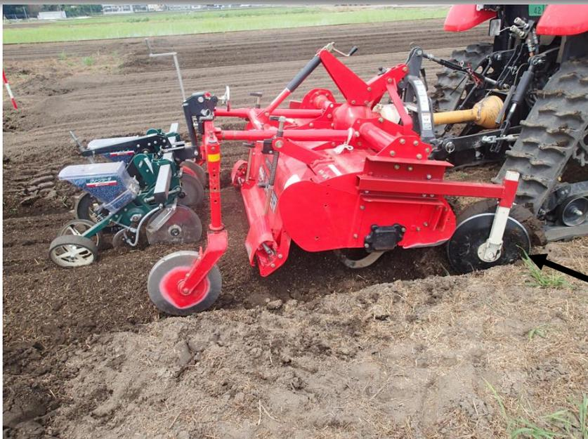
サイドディスクを取り付けるだけのシンプルな構造
