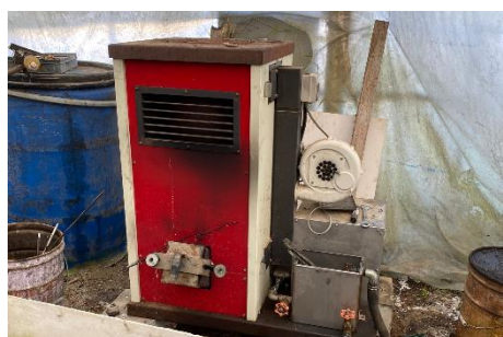
ハウスの廃食油暖房機
