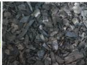
【完成したバイオ炭】 チップ化することによって、炭化効率が良く、均一な炭ができる
