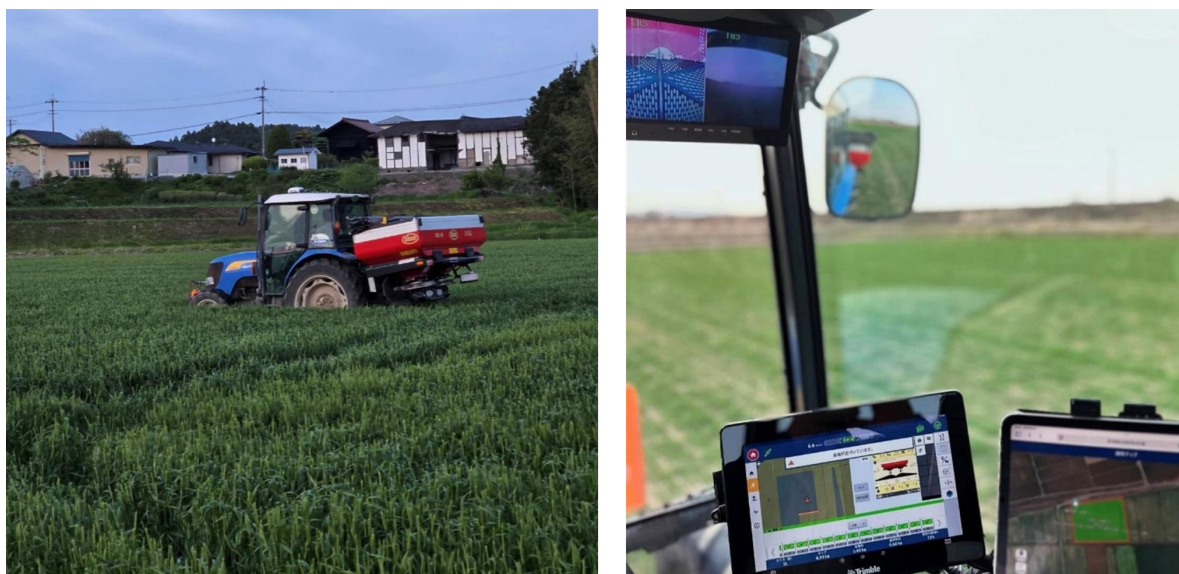
図1 自動操舵トラクターによる肥料散布（左）とセクションコントロール機能の利用（右）
