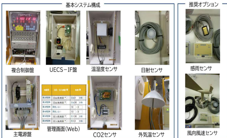
図4 複合制御盤「FARMATE」のシステム構成
