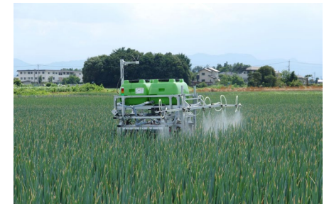
ねぎの自動農薬散布ロボット
