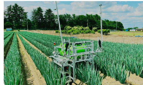
ねぎの自動農薬散布ロボット
