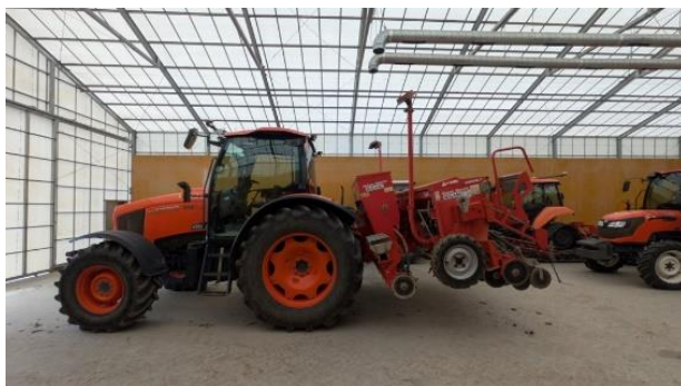
播種機を装着した自動操舵トラクタ
