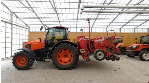
播種機を装着した自動操舵トラクタ
